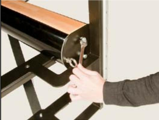
44) Die vier hinteren Bolzen nur eben einführen, nicht festziehen, bevor alle eingesetzt sind.
