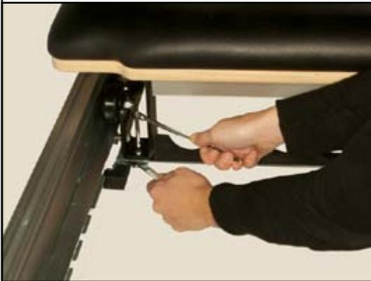
27-28) Oberen Federhaltetestab durch Ausschrauben der Bolzen rechts und links lösen und herausnehmen.
