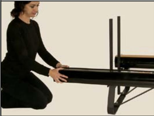
26) Sfila i carter dei longheroni con una trazione attenta in senso longitudinale e appoggiali in posizione sicura, piana, lontana da elementi ruvidi o spigolosi che possano danneggiarli.
